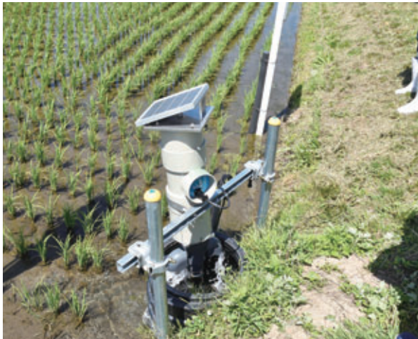
▲給水と排水を制御できる装置
